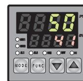
ヒーター温度表示－9℃以内に設定すれば、過昇防止アラームランプは解除されます。
